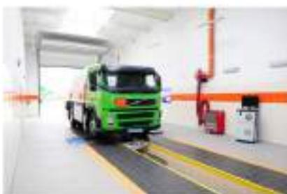
Linia diagnostyczna do badania pojazdów o dmc powyżej 3,5 t, w tym samochodów ciężarowych, autobusów, ciągników rolniczych, przyczep oraz pojazdów z napędem 4x4.
