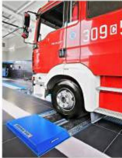
Urządzenie rolkowe do badania układów hamulcowych pojazdów o dmc powyżej 3,5 t, w tym samochodów ciężarowych, autobusów, ciągników rolniczych, przyczep oraz pojazdów z napędem 4x4.
