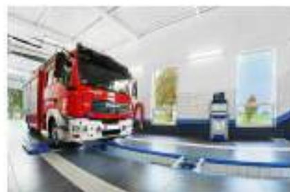
Linia diagnostyczna do badania pojazdów o dmc do i powyżej 3,5 t, w tym samochodów osobowych, dostawczych i ciężarowych, autobusów, motocykli, ciągników rolniczych, przyczep oraz pojazdów z napędem 4x4.
