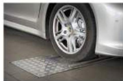
wewnętrzne zabezpieczenia testera umożliwiają przejazd pojazdów ciężarowych bez konieczności zakładania dodatkowych pokryw
