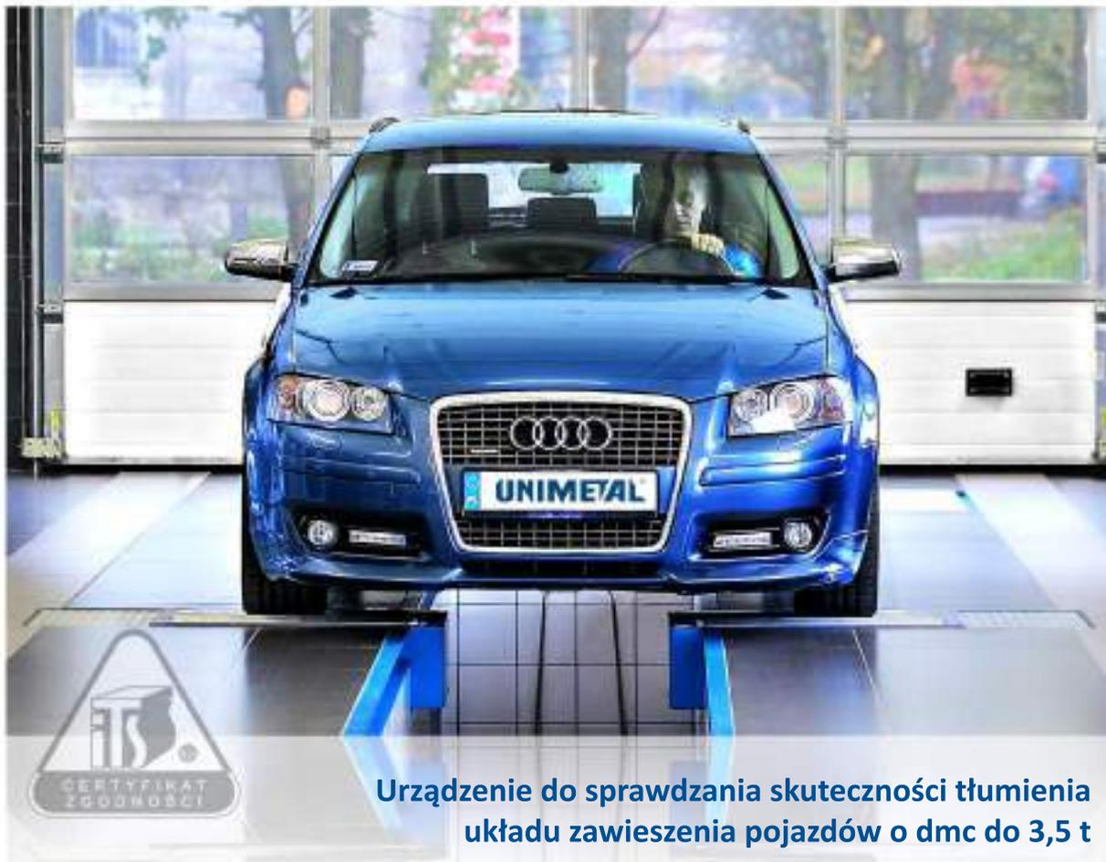
Urządzenie do sprawdzania skuteczności tłumienia układu zawieszenia pojazdów o dmc do 3,5 t
